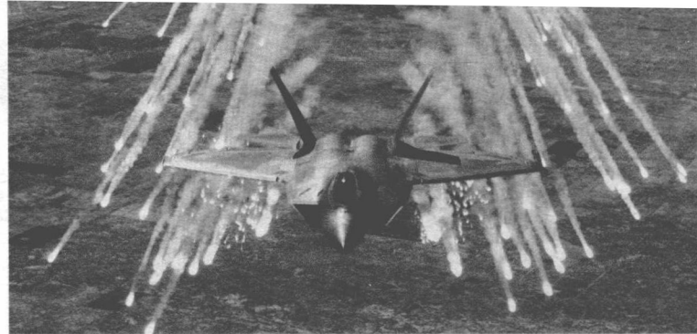
↑ F/A-22A正在投下曳光诱饵弹。诱饵弹的发射位置于主起落架舱的正后方。
