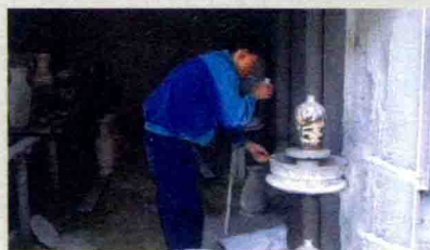
青花瓷的制作 往绘制好图案的素胎上喷制釉
