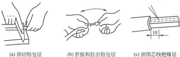
图 1.12 铅包线线头绝缘层的剖削
