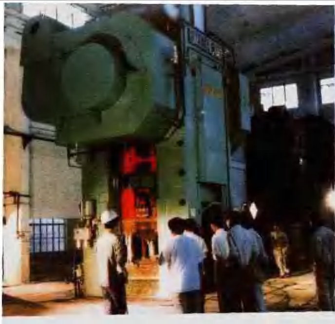
▲ 第二重型机器厂与联邦德国奥姆科 公司合作制造的 MP 型 4000 吨热模锻压力机在 总装试车
