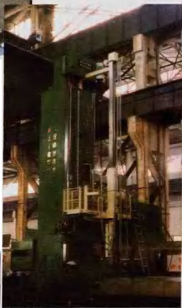
▼北京第一机床厂与联邦德国瓦德里希·柯柏 公司合作生产的 5 × 17 米 数控龙门铣床
