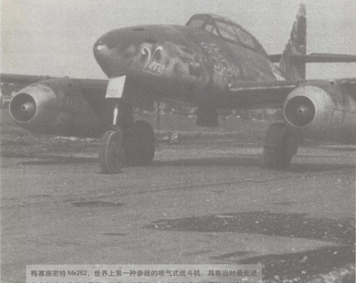
梅塞施密特 Me262，世界上第一种参战的喷气式战斗机，具有当时最先进的空气动力学设计思路，但是它却受到 Jumo004 发动机的困扰，这种发动机的寿命只有 25 个小时。照片中领队的飞机是一架双座型 Me262B-1a。
