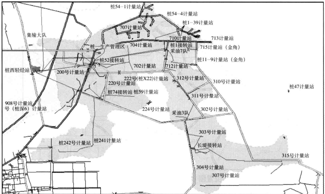
长堤油田集输系统管网分布统图 (桩西采油厂地质研究所编制, 2005年)
