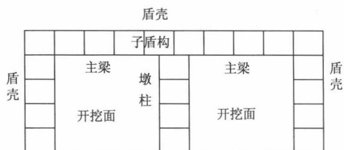
图1—1 框架桥盾构横断面图
