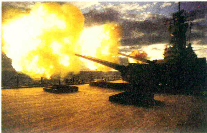
左图：一艘美国海军“衣阿华”级战列舰的16门406毫米主炮（三联装）正在进行齐射，炮弹出膛时的强烈火焰让人头晕目眩。
