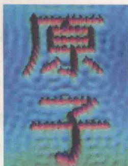
用STM技术将铁原子排列成“原子”二字
