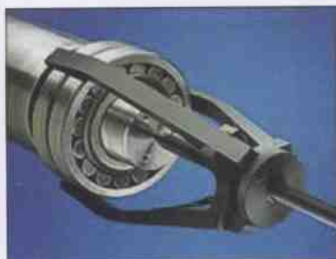
滚动轴承拆卸
