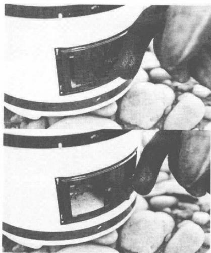
七輪の火力調節は、取り入れる空気の量で調節する。上は空気窓を閉じて最小火力、下は全開で最大火力。思いどおりの火力にできるようにできれば一人前だ
