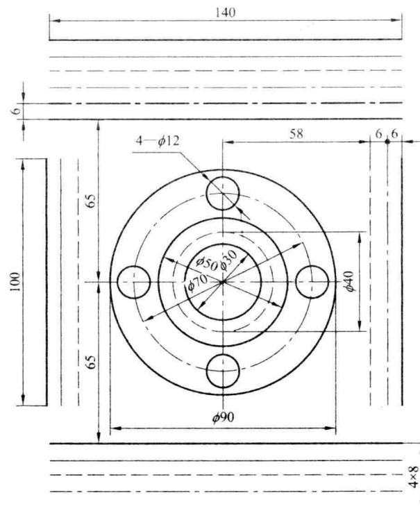
1-6 标注尺寸练习：分别填画箭头、标注尺寸、尺寸数字在图上按1:1比例量取(取整数)
