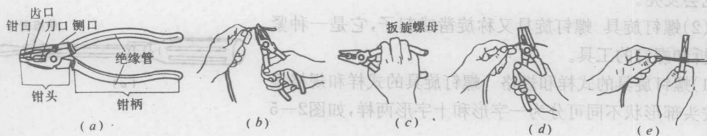
图2—7 电工钢丝钳的构造及用途
