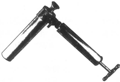
图 1-4 19 世纪 20 年代在英格兰使用的 Owens 喷射式尘粒计数器
