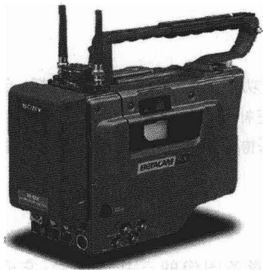
图 1-2-6 电视摄像机的录像部分
