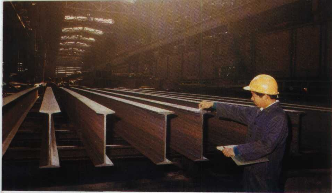
包钢轨梁厂检验人员正在检验大型工字钢。
