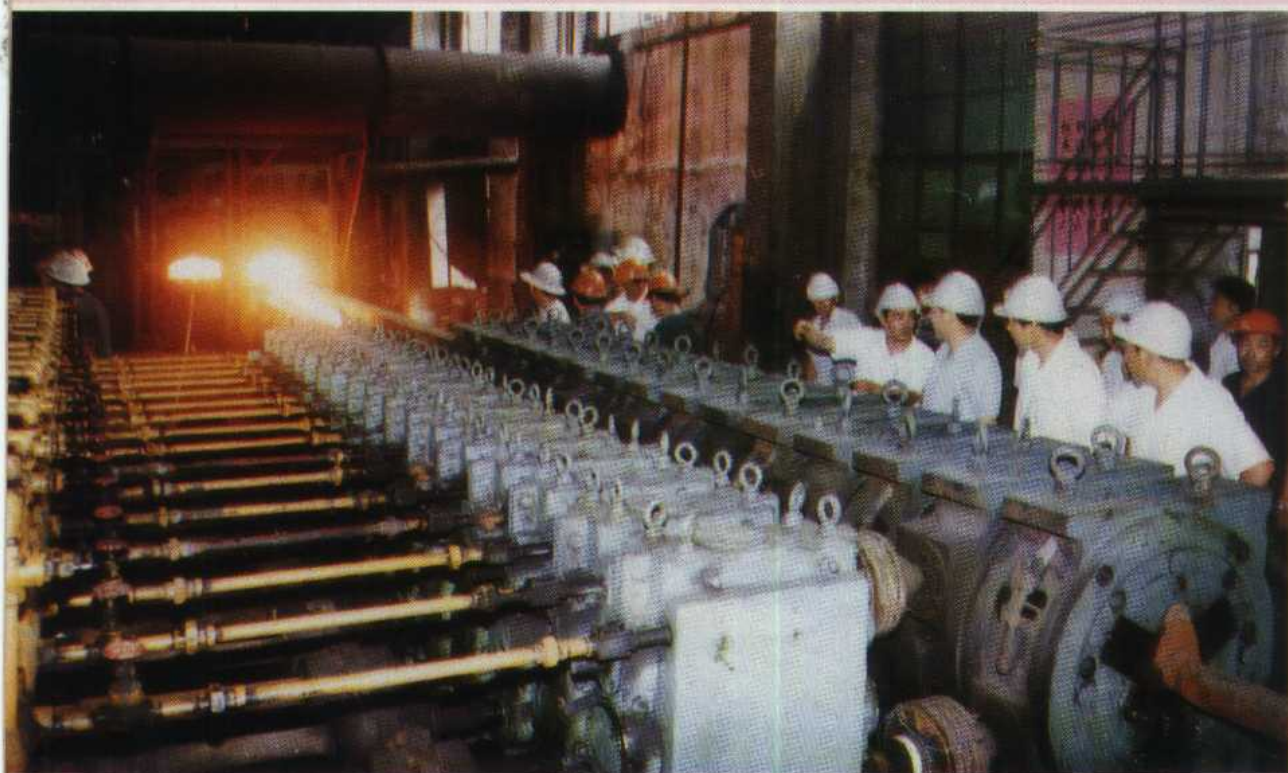
我国自己设计，烟台钢管厂制做，并与冶金部钢铁研究总院共同攻关改造的我国第 一台集中差速式涨力减径机，1986年8月通过了部级鉴定，投产后可生产直径32-76×2.5-4 毫米热轧无缝钢管。
