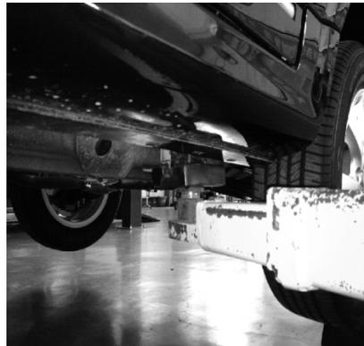
⑥ 当车轮离地 20 cm 左右时,轻推车体复查举升垫,确认安全后再次举升,车体达到需求高度后锁定举升机,严禁超载或产生偏差等各种不符合使用要求的违规作业。
