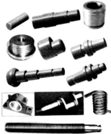
图 1.3 普通车床适合加工的零件类型
