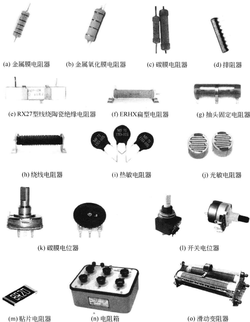
图 1.3 各种常用电阻器的实物图
