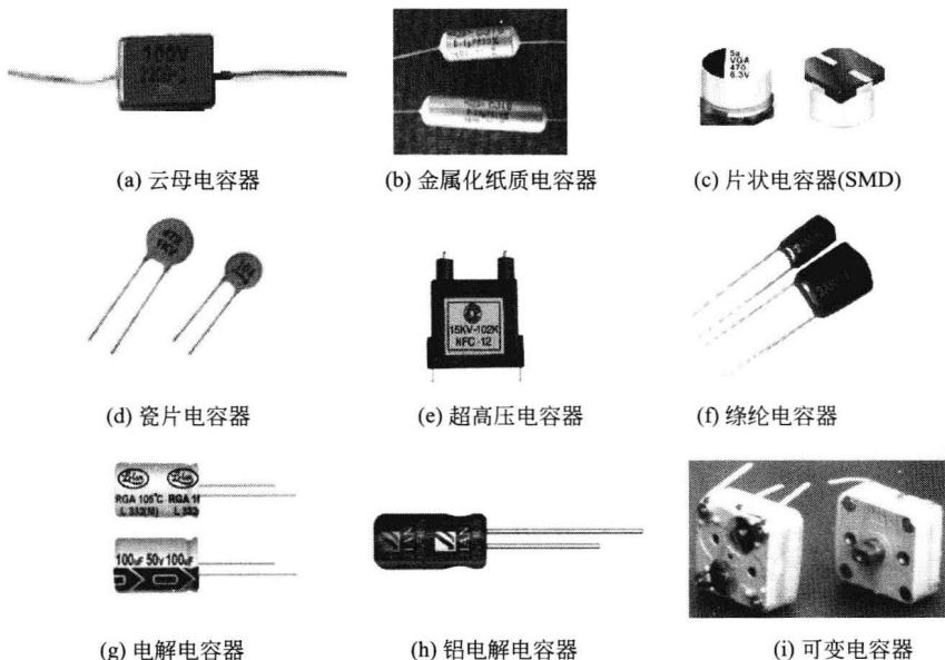
图 1.5 各种常用电容器的实物图
