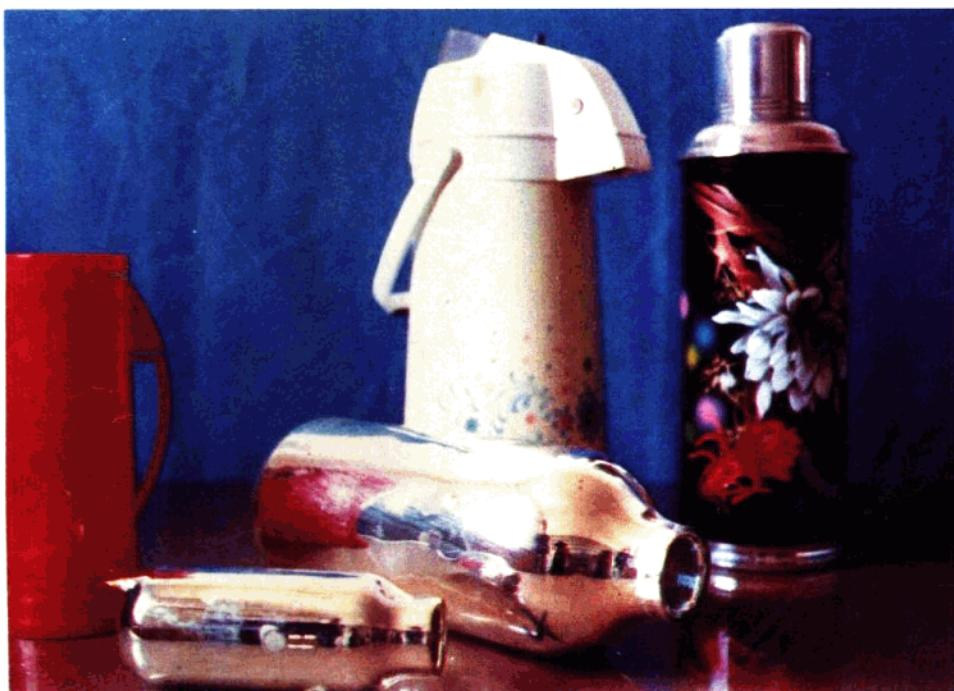
中国保温瓶产量世界第一，是人民生活的必需品，以含银量占63%的硝酸银作为主要原料。在瓶胆玻璃的夹层内壁上，通过化学反应还原成银膜的镀银工艺，在工业大生产中会耗用大量的白银。1981年生产“长城牌”保温瓶的上海保温瓶二厂，从热辐射理论上探索出瓶胆保温机理。发明了“保温瓶瓶胆薄层镀银和应用工艺”，现已在国内推广。从1981年～1985年，共节约硝酸银134.46吨，折合白银84.7吨。以每公斤硝酸银内含630克白银的实际价值计算，已获效益人民币5230万元。
