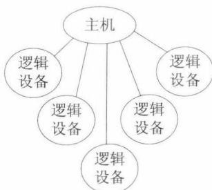
图 1.6.4 USB 逻辑拓扑结构
