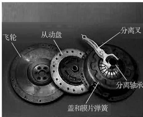
图 2-2-1 膜片弹簧离合器的组成
