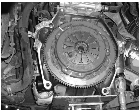
图 2-2-9 离合器压盘总成及从动盘的拆卸
