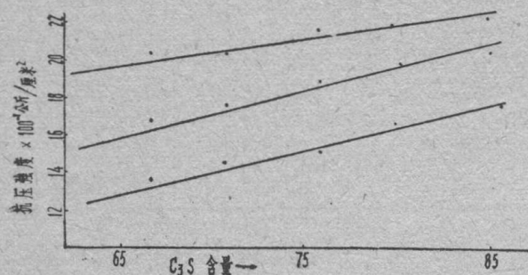
图6 水泥中C 3 S含量与抗压强度的关系
