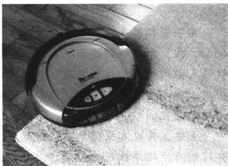
图 P-2 Roomba ® 是美国麻州 Burlington iRobot 公司制作的地板吸尘机器人, 该机器人已经得到了广泛的应用。Roomba 采用了基于行为的编程机制 (图片由美国麻州 Burlington iRobot 公司提供)。
