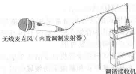
图 1-9 无线麦克风信道接收示意图
