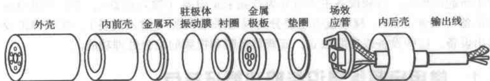
图 1-3 驻极体电容麦克风的结构示意图
