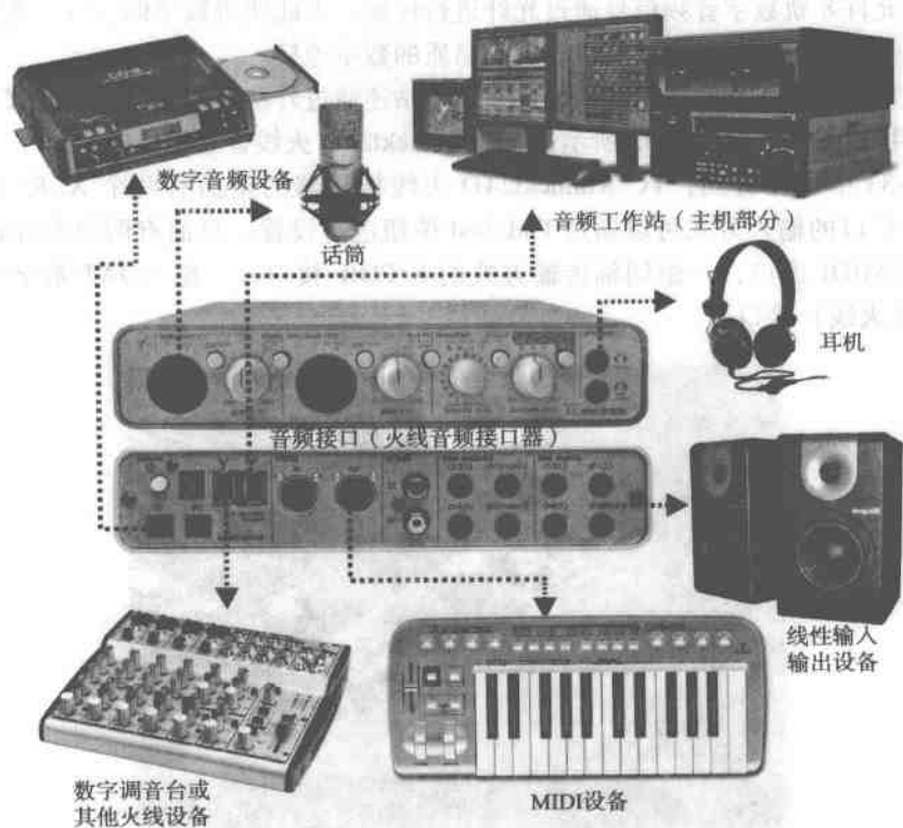
图 1-34 音频工作站的设备连接图
