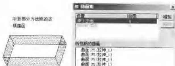
图 1-7 选取拔模曲面
