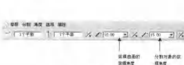
图 1-23 输入拔模角度
