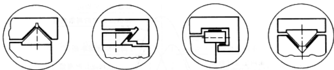
图 1-5 工作台、滑座贴塑导轨
