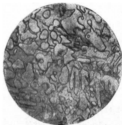
图 1 2Y_2O_3 \cdot Al_2O_3 化合物和 3Y_2O_3 \cdot 5Al_2O_3 化合物的晶体
