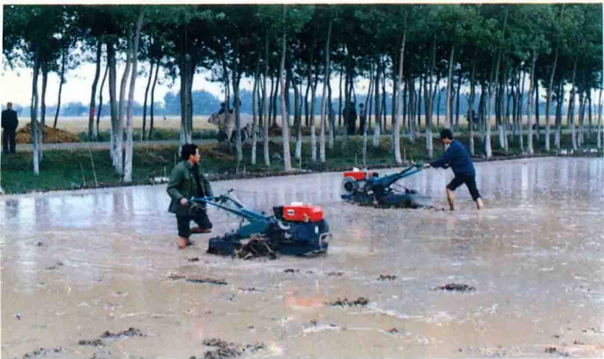
“农机走进千万户，生产加工跑运输；父老乡亲乐开怀，从此奔上富裕路”。图为手扶拖拉机在翻耕水田时的情景。
