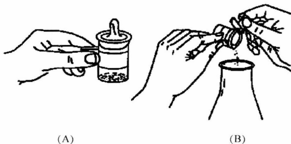
图 1-2-2 称量瓶的使用方法 (A) 称量瓶拿法 (B) 从称量瓶中敲出试样
