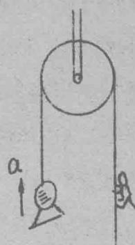
按题意，开始时，猴和镜在同一水平面上。当两者平衡时，它们的质量应该是相等的。在(1)与(2)两种情况下，根据牛顿第三定律，猴子向上或向下爬时，绳子对猴子的拉力应等于绳子对镜子的拉力，又由于两者质量相等，所以在相同的拉力作用下，上升的加速度相等。所以，猴子和镜子在任何一时刻都在同一高度。
