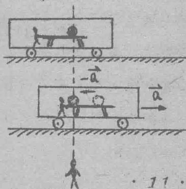
(3)为什么同一个钢球运动状态，观察者甲和观察者乙会得出两种不同的结论呢？这是因为两个观察者在观察钢球运动时，所取的参照系不同。前者取地球，是较好的惯性系，后者取火车，是非惯性系。牛顿定律只有对惯性系才适用，对非惯性系不能适用。要使牛顿第二定律在非惯性系中也能成立，必须引进惯性力的概念进行修正， $\overrightarrow{F}_{\text{惯}} = -(\overrightarrow{m}\overrightarrow{a})$ ，可见当火车加速向前运动时，小球在惯性力作用下产生相对加速度，其方向与火车加速度方向相反。
