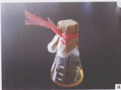
图 9. 液体培养基摇瓶培养。a. 培养瓶瓶口用 16 层纱布和纸包扎灭菌。b. 接种后, 去掉包扎纸摇瓶培养。
