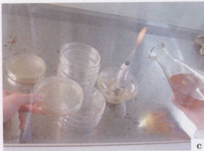
图 8. 倾注平板。a. 取棉塞并在火焰上掠烧瓶口。b. 倾到培养基于无菌平板中。c. 水平移开倾倒好的平板。d. 培养基凝固后倒置。
