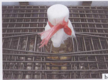
图 9. 液体培养基摇瓶培养。a. 培养瓶瓶口用 16 层纱布和纸包扎灭菌。b. 接种后, 去掉包扎纸摇瓶培养。
