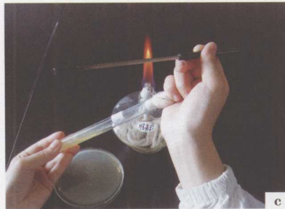
图 5. 平板划线。a. 接种环灭菌。b. 钩菌。c. 盖菌种棉塞。d. 皿盖开启一小口划线
