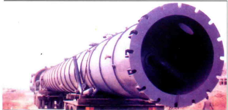
运往工地的抽提塔 Extraction tower
