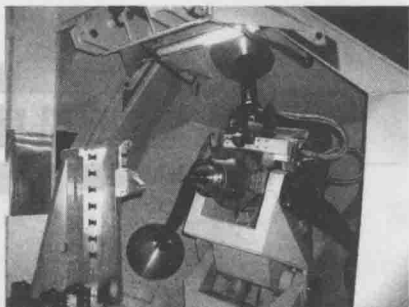
图 1.1.6 虚拟轴加工中心
