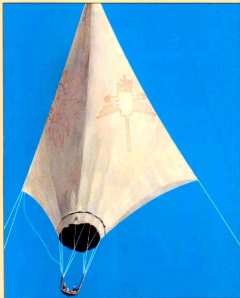
两位驾驶员坐在用芦苇束制成的摇篮中测试秃鹰1号热气球。
