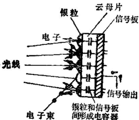
图1.1-2 嵌镍板的光电转换作用
