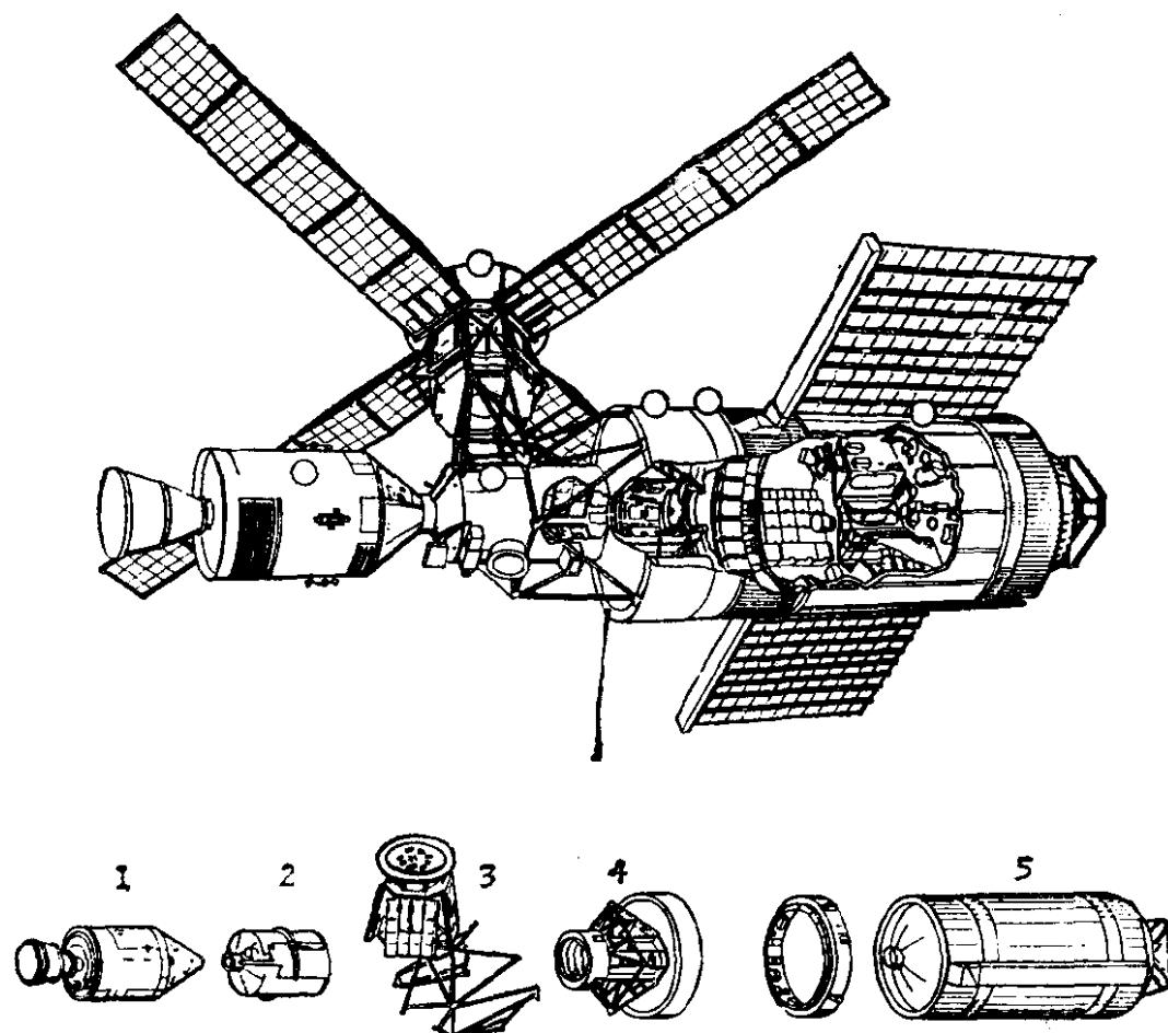
这张图显示了空间实验室的太阳翼和五个主要组成部分：轨道工场、气闸舱、对接接合器、太阳观测台和指令服务舱。阿波罗指令服务舱是负责后勤保障工作的飞行器，它与对接接合器前端相对接；对接接合器提供对接的接口，有许多实验将在对接接合器的内部完成；气闸舱把对接接合器和轨道工场连接起来；轨道工场是航天飞行员的生活和工作的地方；太阳观测台安装在对接接合器上面的结构上。
