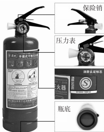
图1-1-6 手提式干粉灭火器的外部构造
