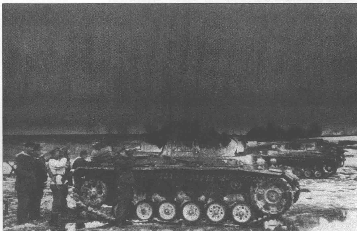
为军官组观察提供掩护中的III号坦克，近处的坦克战术编号可能为“864”。可以看到，更宽的冬季履带避免了坦克频繁陷入泥泞之中。
