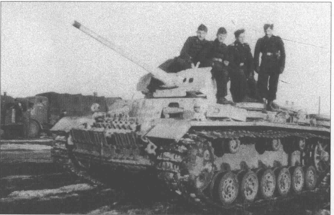
8连的一辆Ⅲ号J型坦克，注意其使用的是冬季履带，又名东线履带。冬季履带是通过加大履带对地接触面积，来防止坦克陷于泥泽或冰雪中。
