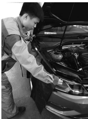
图1-1-9 安装右翼子板布
