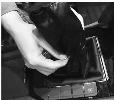
图1-1-3 安装换挡杆套
