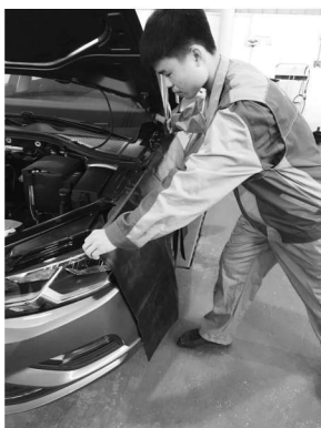
图1-1-8 安装左翼子板布
