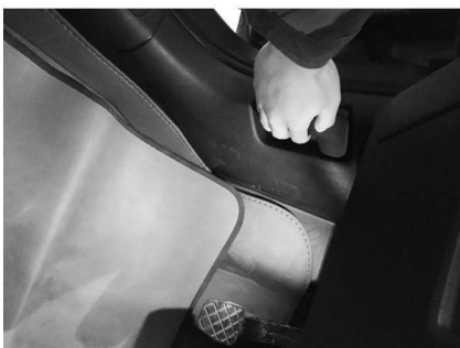
图1-1-5 打开发动机拉杆
