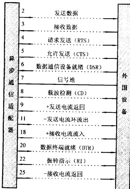
**ACIA interface signals for MPU** 微处理机单元异步通信接口适配器接口信号 微处理机单元(MPU)与ACIA的连接信号。在某些系统中，ACIA连接至一典型的MPU，是经由一个8位数字双向数据总线，此外还包括三条芯片选择线路、一条寄存器选择线、一条中断要求线、一条读/写控制线及一条启动线而完成的。
