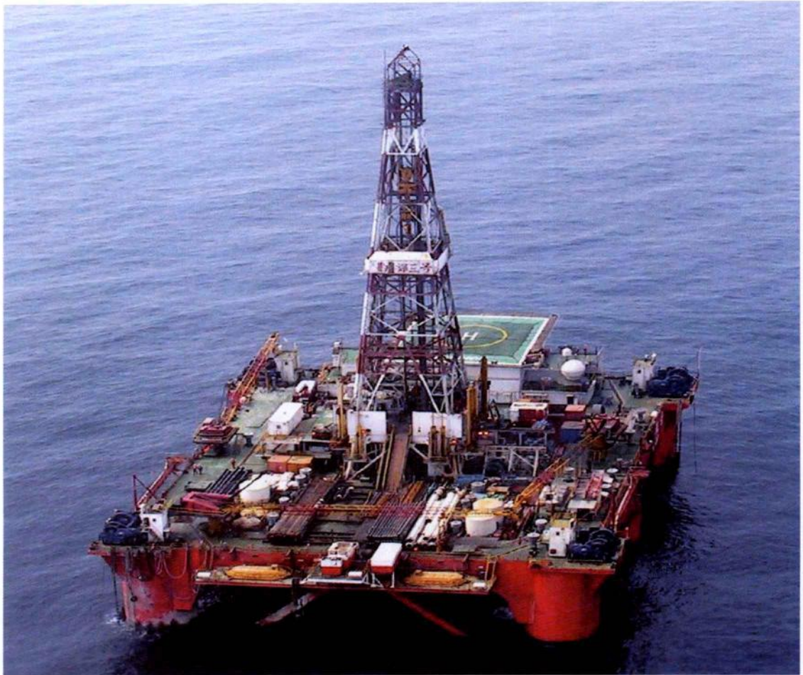
实施平湖油气田勘探阶段钻探的钻井平台之一——“勘探三号”半潜式钻井平台 (上海船厂 1984 年建造)
