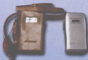
CJG10Z型便携式智能 光干涉甲烷测定器 (俗称“数字光瓦”)
