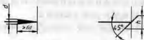
a 箭头(d:粗实线的宽度) b 斜线(h:尺寸数字高)
