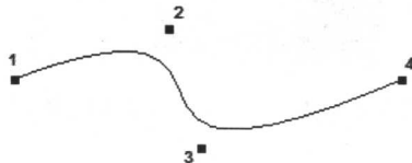
图 1-4 使用样条函数创建一条连接点集的平滑曲线
