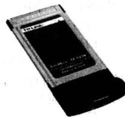
不同类型的网络（如以太网、ATM、FDDI、令牌环等）、不同类型的传输介质（如双绞线、细缆、光纤、无线等）、不同速率的带宽（如 10Mbps、100Mbps、1000Mbps），以及不同的应用（如工作站、服务器）应当分别选用不同的网卡。
