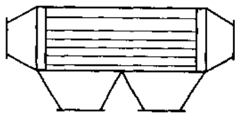
图 2-1 重力沉降室结构
