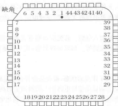
图 1-2 集成电路 PLCC 封装方式
