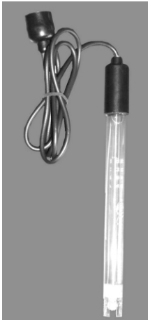
图 11-6 E201-9C 型复合 pH 玻璃电极
