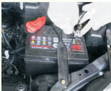
图1-14 拆卸蓄电池接地电缆
